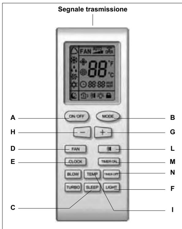
Per il corretto funzionamento del telecomando è necessario che non ci siano ostruzioni tra esso ed il ricevitore situato nel fan coil. Non lanciare o far cadere il telecomando per possibile causa guasti. Non versare liquidi sopra il telecomando. Non posizione il telecomando a contatto diretto con i raggi del sole o a contatto con fonti dirette di calore.
